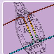
Das Luftkühlssystem wirkt einer Überhitzung der Geräte bei Dauerbelastung entgegen
